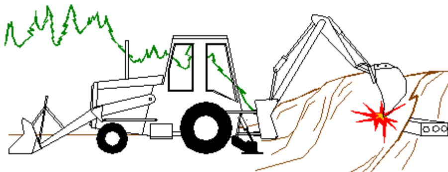
Figura 1 – Contatto con linee elettriche interrante
